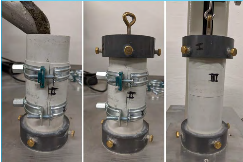
Abbildung 90: Befüllen der fixierten Probekörperhälften (links), Anbringen der Lasteinleitungsplatte (mitte), Probekörperhälften mit gelöster Fixierung unter der Zugvorrichtung (rechts)
