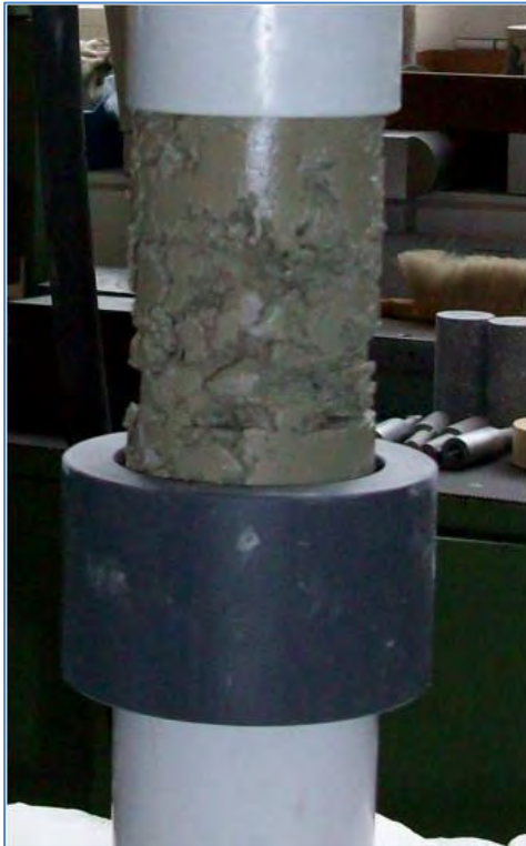
Abbildung 96: schlechter Verdichtungsgrad bei Verwendung der Humm-Sonde [132]
