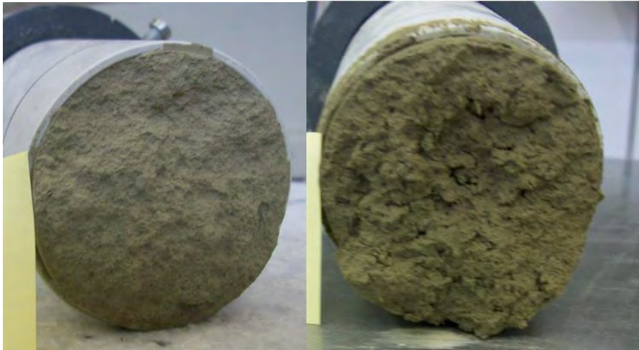
Abbildung 80: Bruchbild nach zentrischem Zugversuch zweier erdfeuchter Zementleime, links w/z=0,18 , rechts w/z=0,25 . [132].
