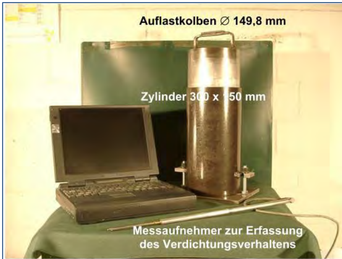
Abbildung 24: Rüttelproctor zur Erfassung des Verdichtungsverhaltens bei dynamischer Verdichtung [22]
