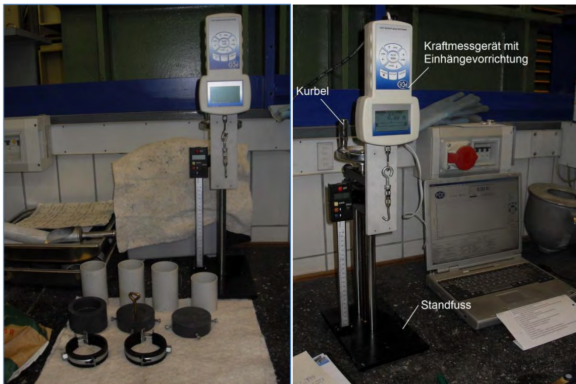
Abbildung 91: Variante 3 mit Versuchsstand und Einzelteilen [134]
