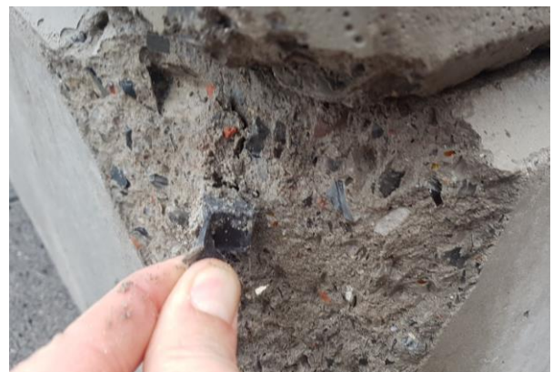
Abbildung 1: Bruchstücke von Schwergewichtsmauerwerk, das unter Verwendung ungeeigneter Ausgangsstoffe hergestellt wurde (Glas, Gummi und andere Abfälle).
