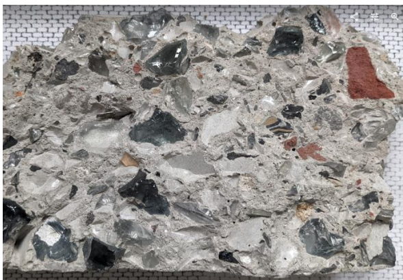
Abbildung 1: Bruchstücke von Schwergewichtsmauerwerk, das unter Verwendung ungeeigneter Ausgangsstoffe hergestellt wurde (Glas, Gummi und andere Abfälle).
