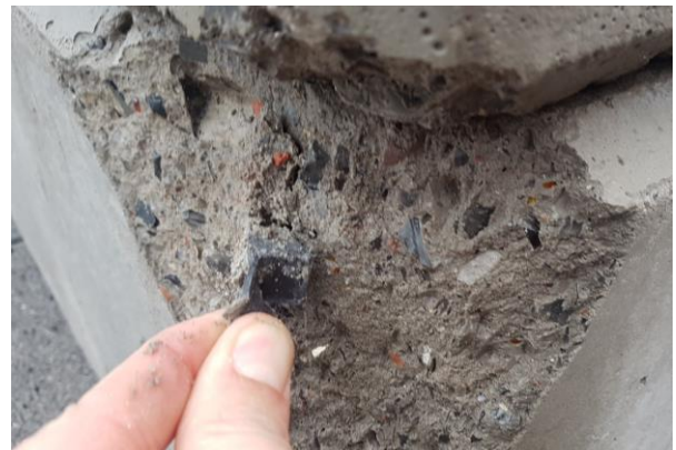
Abbildung 1: Bruchstücke von großformatigen Systemsteinen, die unter Verwendung ungeeigneter Ausgangsstoffe hergestellt wurden (Glas, Gummi und andere Abfälle)
