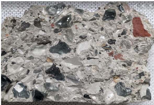
Abbildung 1: Bruchstücke von großformatigen Systemsteinen, die unter Verwendung ungeeigneter Ausgangsstoffe hergestellt wurden (Glas, Gummi und andere Abfälle)
