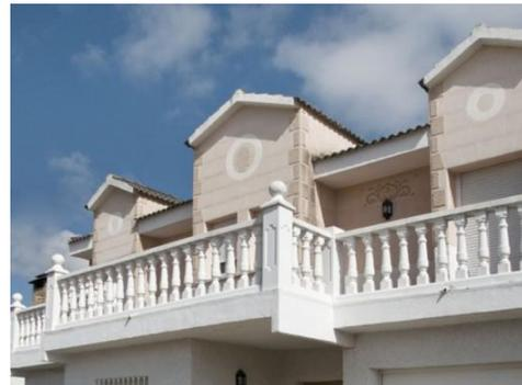
Balustraden aus Beton werden einschließlich der Zubehörteile wie Eckpfeiler, Hand- und Fußläufe im Garten- und Landschaftsbau ebenso verwendet wie für die Errichtung von Geländern und Absturzsicherungen.
