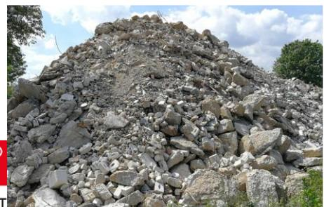
Im Anschluss haben wir die Gelegenheit zur Besichtigung der ca. zwei Kilometer entfernten Bauschuttzubereitungsanlage der REMONDIS GmbH & Co. KG. Dort findet die Annahme und Aufbereitung von mineralischen Abfällen (Bauschutt, Straßenaufbruch, Betonbruch, Gips, usw.) statt, sowie der Verkauf von zertifizierten Recyclingbaustoffen.
